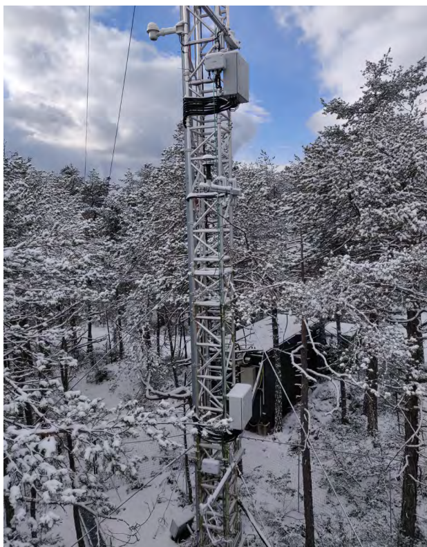
קרן מכשירים ומגדל למדידה של הסרת פחמן דו-חמצני ביער אורנים באלפים האוסטריים, ינואר 2024. במהלך החורף היער פולט יותר פחמן בנשימה מאשר קולט פחמן בפוטוסינתזה | צילום: אלון אנגרט
