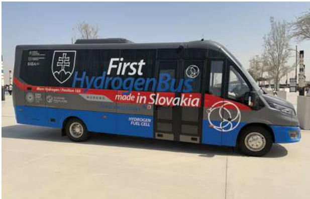
אוטובוס מונע מימן – תערוכת אקספו, דובאי, מרץ 2022. לשימוש בתאי דלק מימן בתחבורה יש יתרון על פני שימוש בסוללות, בעיקר בכלי רכב שדורשים סוללות גדולות מאוד, כגון משאיות ואוטובוסים. זמן התדלוק של כלי רכב מונעי מימן קצר (כמו רכבי בנדזין), וטווח הנסיעה לתדלוק בודד ארוך יחסית | צילום: נדיה צימרמן
