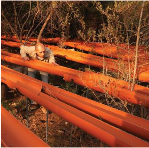
מערכת שקתות לניסוי הפחתת גשם שד"ר קליין וצוותו הקימו ביער ישעי ליד בית שמש. המערכת מאפשרת תנאי בצורת בחלקת יער, ולאפיין מקרוב את תגובות העצים ליובש מבחינת שטפי המים והפחמן | צילום: ערוץ ארטה (צרפת-גרמניה)
