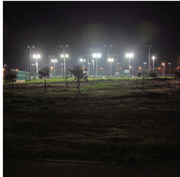
תאורת מגרשי הספורט הסמוכים ליפארק השלולית, בנתניה מפריעה לפעילות דורחיים ומינים אחרים בשלולית החורף. התקנת מצחיות על גופי התאורה וכיונם לזווית חדה הביאו לירידה בעוצמת התאורה בשלולית ב-95%, ולעלייתה במגרש המשחקים ב-54% באדיבות: אור מכוון
