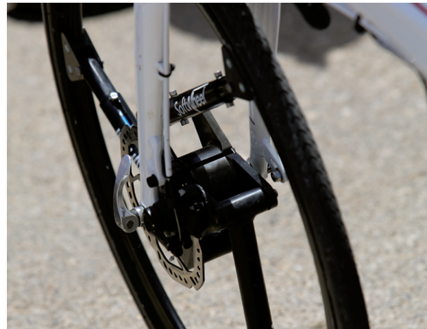
פיתוחים שהוצגו לאחרונה בכנס EcoMotion: מימין - SoftWheel, פטנט ישראלי למזעור הזעזועים בגלגל; משמאל - גלישת כביש חשמלית בתלת גלשן | צילומים: אסף קלינגר
