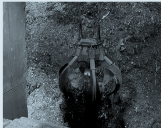
מתקן השבת אנרגיה מפסולת בשיטת מצע מרחף, ניקלסדורף, אוסטריה. מנוף המצבט מבצע ערבוב והומוגניזציה של הפסולת, ומעביר אותה מבור האיגום אל תנור השרפה | צילום: ניצן לוי
