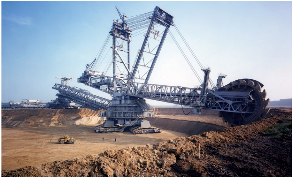
כריית פחם חום (lignite) באמצעות מחפר ענק המופעל במכרות פתוחים, ב-Hambach (גרמניה) | באדיבות חברת ThyssenKrupp AG ©
