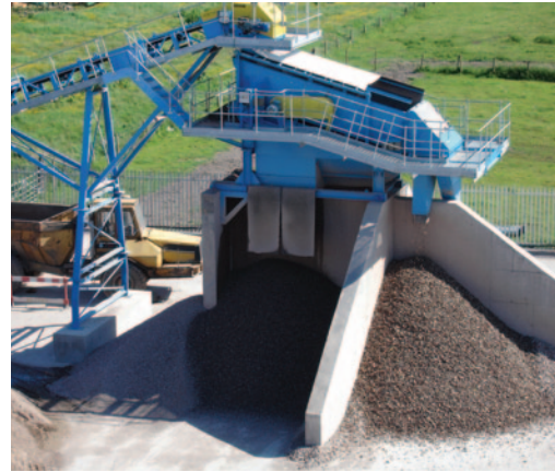
תהליך מחזור פסולת הבניין: הפסולת מועמסת על מכבש, ולאחר תהליך המעיכה מועברים הגורמים לנפה לצורך מיון | צילום: Peter Craven, חברת CDEGlobal ©
