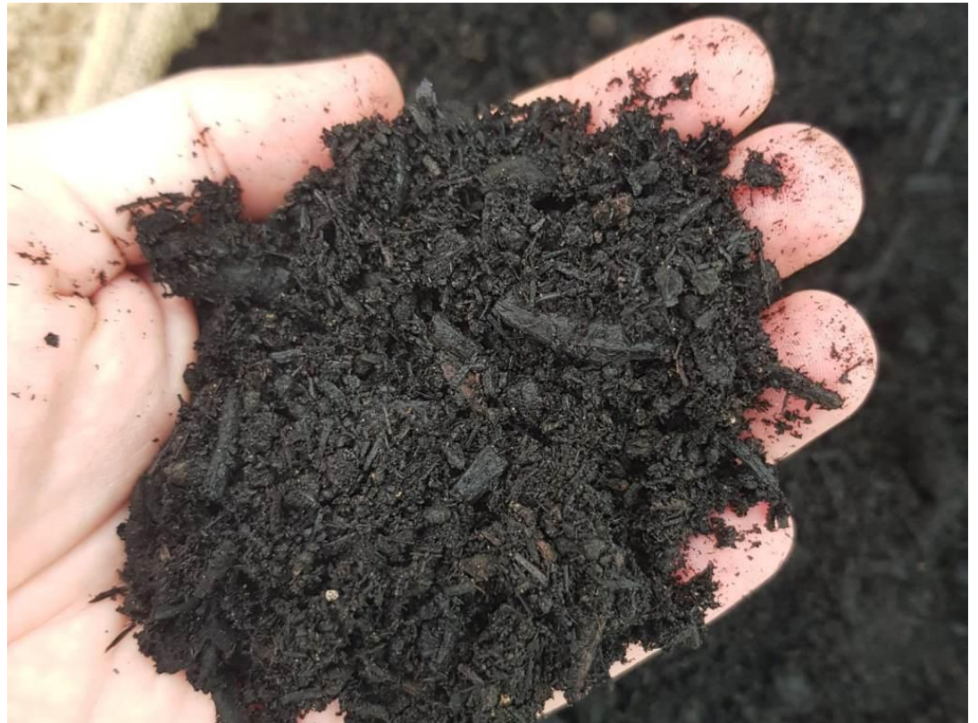
פחם ביולוגי (bio-char) שהופק מפסולת גזם משולב בבוצה – מקבע פחם ומשפר את פוריות הקרקע | באדיבות חברת קו-אנרג'י בע"מ
