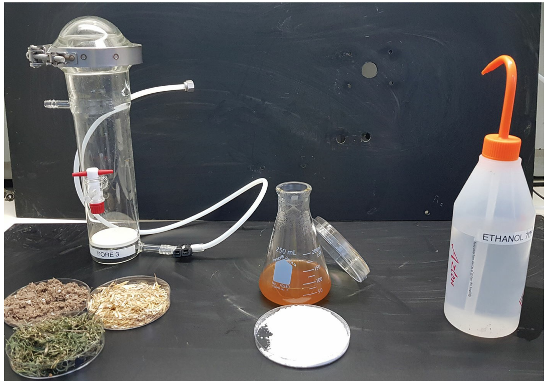
אילוסטרציה של תהליך ייצור אתנול מפסולת צמחית. משמאל: דוגמאות של סוגי פסולת שונים (קש, פסולת נייר ונום) ביחד עם הריאקטור המעבדתי; במרכז: הסוכרים המופקים מהתהליך, יחד עם השמרים; מימין: האתנול המופק מהתהליך
