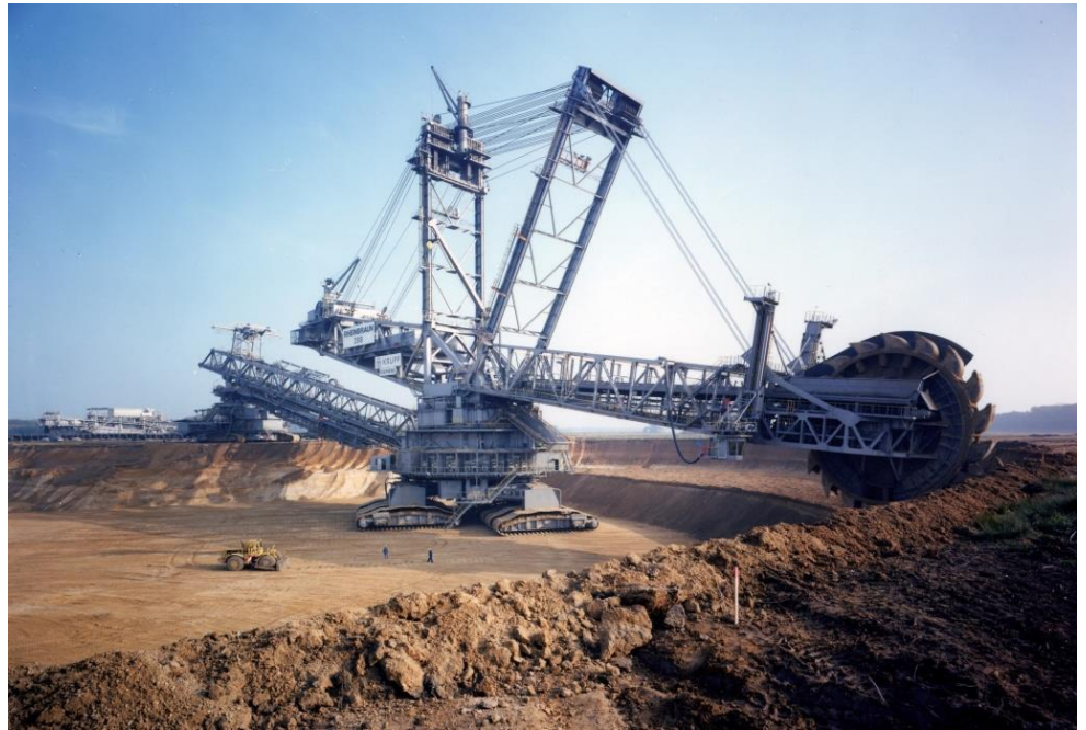
כריית פחם חום (lignite) באמצעות מחפר ענק המופעל במכרות פתוחים, ב-Hambach (גרמניה) | באדיבות חברת ThyssenKrupp AG ©
